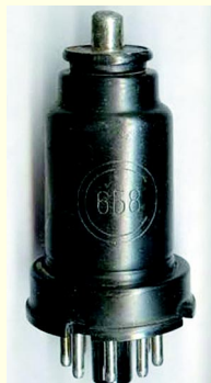
Двойной диод-пентод в металлическом и стеклянном корпусе.
