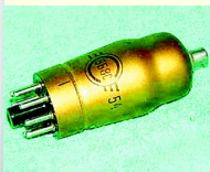
Двойной диод-пентод в металлическом и стеклянном корпусе.
